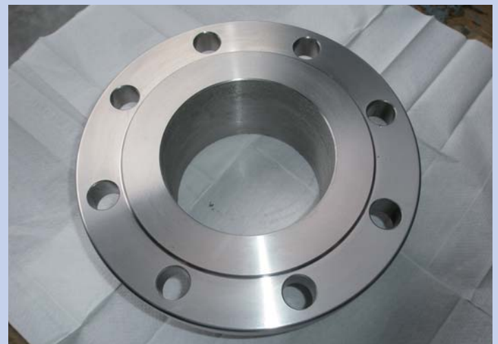
Dezelfde flens na behandeling met Innosoft B570 en Innoprotect B580
